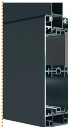
Nos portails cachent dans leur structure des renforts aluminium d'une épaisseur de 10 mm. Ils sont insérés dans les profilés pour recevoir les fixations moteurs ou tout autre accessoire nécessitant une accroche renforcée. Ces renforts assurent une rigidité qui sécurise les efforts mécaniques engendrés à l'ouverture ou à la fermeture du portail. Les lames de remplissage horizontales sont également pourvues de ce système.
